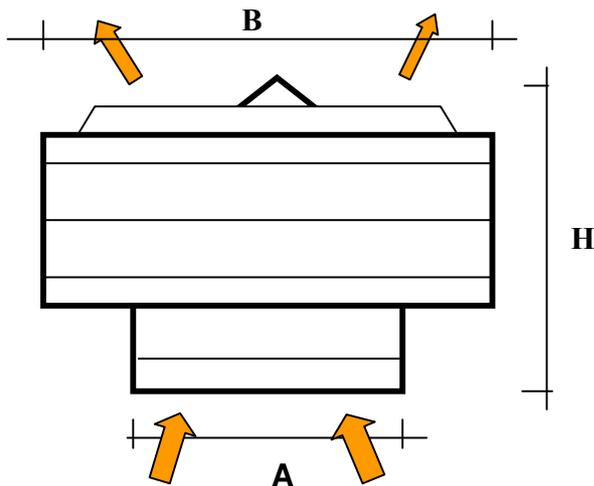
Extractor gravitacional (natural) que permite la salida del aire caliente y contaminado por el tejado de un recinto cerrado.
